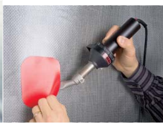
Soudage par points avec le modèle HOT JET S.
