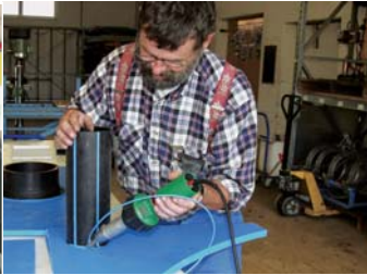
Soudage de pièce moulée avec le TRIAC PID et buse de soudage rapide emboîtée.
